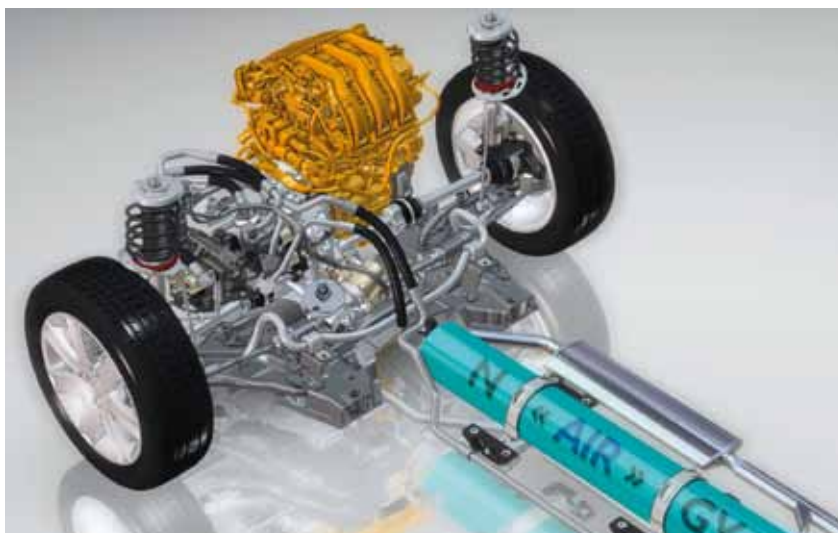
Chaîne de traction HYbrid Air, PSA
